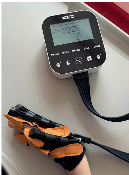
SLIKA 3. UPORABA ROBOTSKE ROKAVICE SYREBO PRI DELOVNI TERAPIJI, KI OMOGOČA VEČ VRST FUNKCIJSKIH VAJ: PASIVNI ALI AKTIVNI TRENING, ZRCALNI TRENING IN TRENING PREKO IGRE PRI NAJSTNIKU Z DESNOSTRANSKO HEMIPAREZO PO MOŽGANSKEM INFARKTU.
